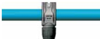
Fissare la presa di derivazione allineando nuovamente le tacche di riferimento ai segni realizzati
