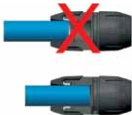
Con l'ausilio di grasso di vaselina o di appositi scivolanti, lubrificare la guarnizione del raccordo ed inserire il tubo nel raccordo fino all'arresto del tubo in corrispondenza della battuta
